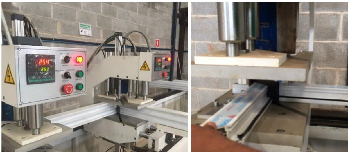
Figura 19 - Máquina realizando a termo fusão entre os perfis.
